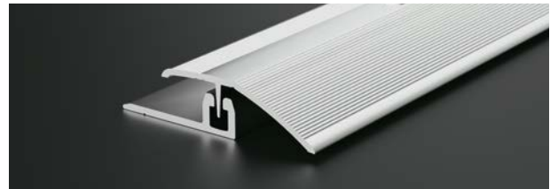
Für Parkett und Laminat: Zweiteiliges Alu-Schraubsystem, höhenverstellbar bis 16 mm, schwenkbar bis 14 mm. Kügele STS Flex
